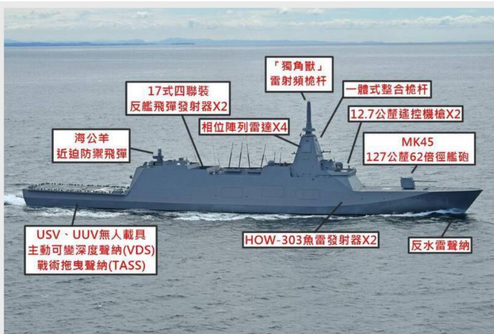
《軍武頻道》圖解介紹最上級護衛艦。(圖片擷取自日本海自，記者吳哲宇製圖)
